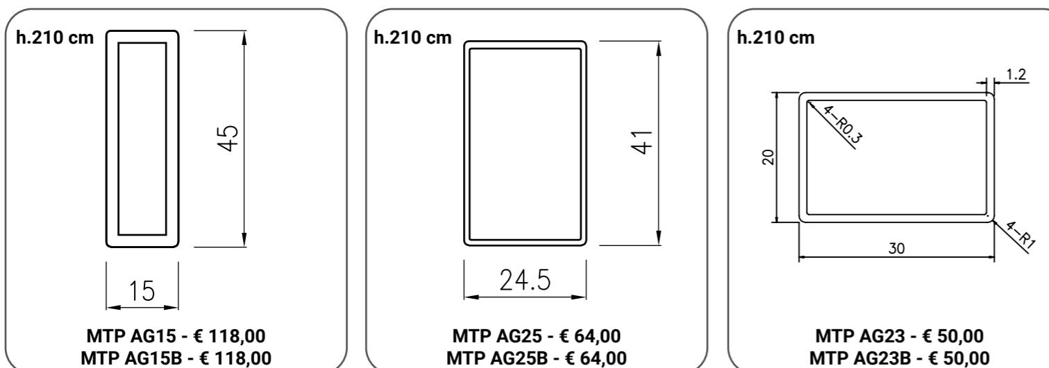
Profili di allungamento in aggiunta. - Additional wall profile adjustment. - Zusätzlicher Verlängerungsprofil. - Profilés pour allongement supplémentaire.
